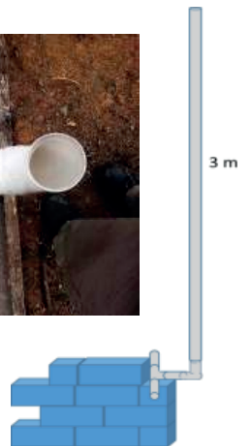
Figura 12. Tubo de PVC para gases de las cámaras del baño
